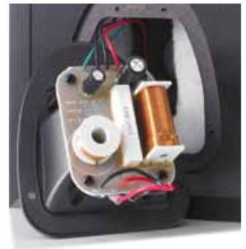
**PURISTISCH:** Die direkt am Kabelterminal montierte Weiche kommt mit fünf Bauteilen aus und senkt so den Wattbedarf.
