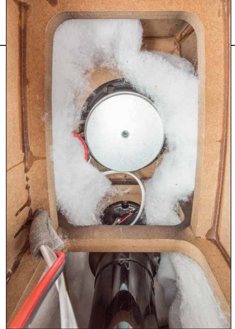
Die Gehäusewände werden mit Ringverstärkungen stabilisiert
