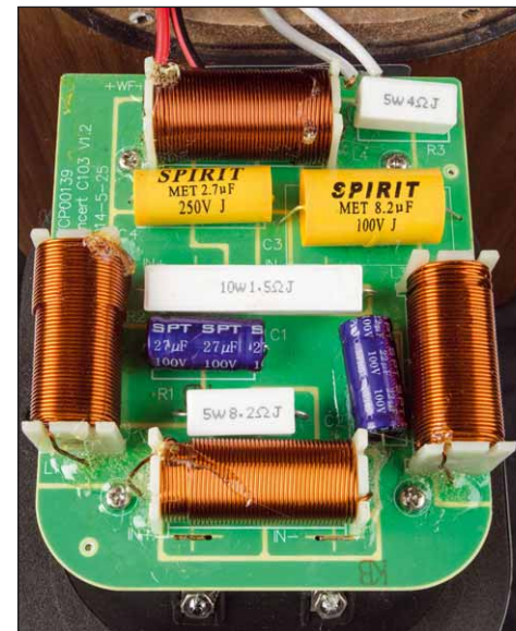
Die am Terminal befestigte Weiche. Bauteilqualität? In Grenzen vorhanden
