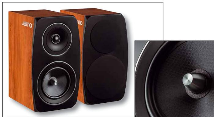
Ein Phaseplug sorgt für Kühlung der Schingspule und verringert zudem Membranresonanzen
