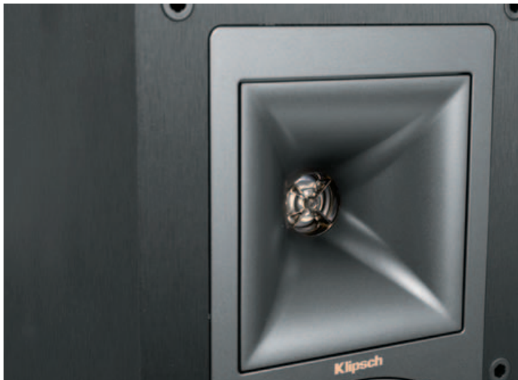
Das 90x90-Grad-Tractrix-Horn verwendet einen 2,5-cm-LTS-Hochtöner (Linear Travel Suspension) aus Aluminium aus der edlen Palladium-Serie für hohe Belastbarkeit, guten Wirkungsgrad und niedrige Verzerrungen.
