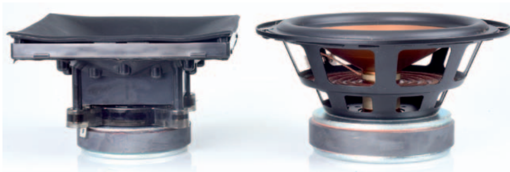
Kammer und Hub: Das Horn links flutet seine Klangenergie in eine rechteckige, rotationssymmetrisch geformte Schallführung. Das Kunststoffmaterial nennt Klipsch „Silikon“. Die Membran des Tieftöners besteht aus „Cerametallic“, der wuchtige Magnet und die Hinterlüftung versprechen großen Hub.
