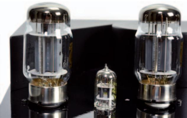
**CLEVER:** Der Lautstärkereglер wurde an einen Motor gekoppelt und kann fernbedient werden. Als Leistungsträger lässt Fezz Audio vier große KT-88 glühen.
