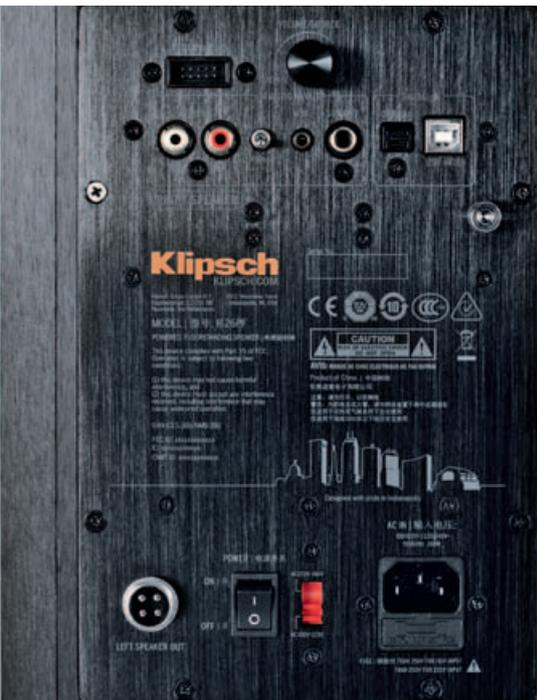
Das Terminal beinhaltet einen rudimentären Steuerungsknopf für Quellwahl und Lautstärke sowie die vier kabelgebundenen Eingänge. Der „Phono“ heißt auch so, wenn er für Linepegel umgeschaltet wird, Besonderheiten sind der Subwoofer-Aus- und der USB-Eingang. Unten links der Anschluss der linken „Slave“-Box mit speziellem Lastmulticore-Kabel.
