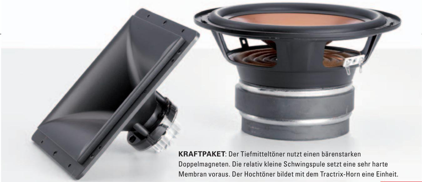
**KRAFTPAKET:** Der Tiefmitteltöner nutzt einen bärenstarken Doppelmagneten. Die relativ kleine Schwingspule setzt eine sehr harte Membran voraus. Der Hochtöner bildet mit dem Tractrix-Horn eine Einheit.
