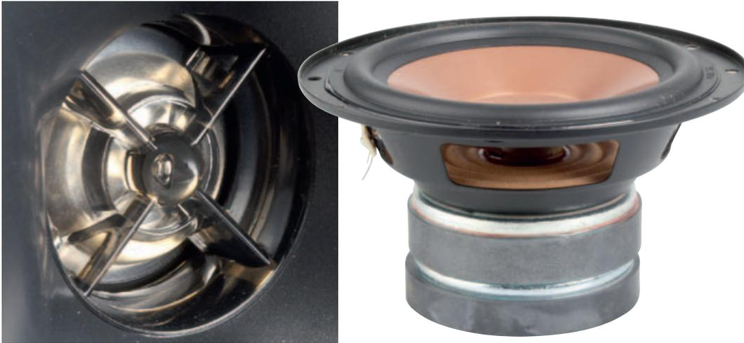
Das quadratische Tractrix-Horn der Klipsch R-15PM vertraut auf eine 2,5-cm-Aluminium-Membran, der Tief-/Mitteltöner auf einen kupferbeschichteten IMG-Konus und einen kräftigen Doppelmagneten. Eine einfach aufgebaute Passiv-Weiche trennt die beiden Bereiche der Zwei-Wege-Bassreflex-Box bei 1800 Hz. Die beiden Treiber sind perfekt ohne sichtbare Schrauben in die Schallwand eingelassen.
