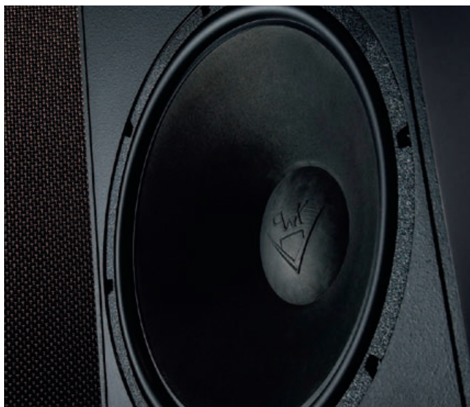
Der mächtige 38-cm-Passiv-Bass auf der Gehäuserückseite wird vom rückwärtigen Schall des frontseitigen Basses angetrieben.
