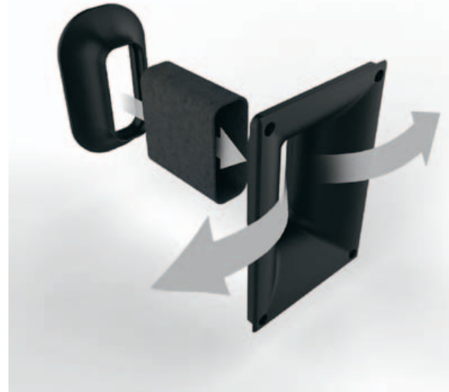
Der Reflextunnel ist auf 50 Hz getunt und sitzt rückseitig. Er ist auch im Innenteil verrundet, um Kompression und Kantenabrissgeräusche zu minimieren.
