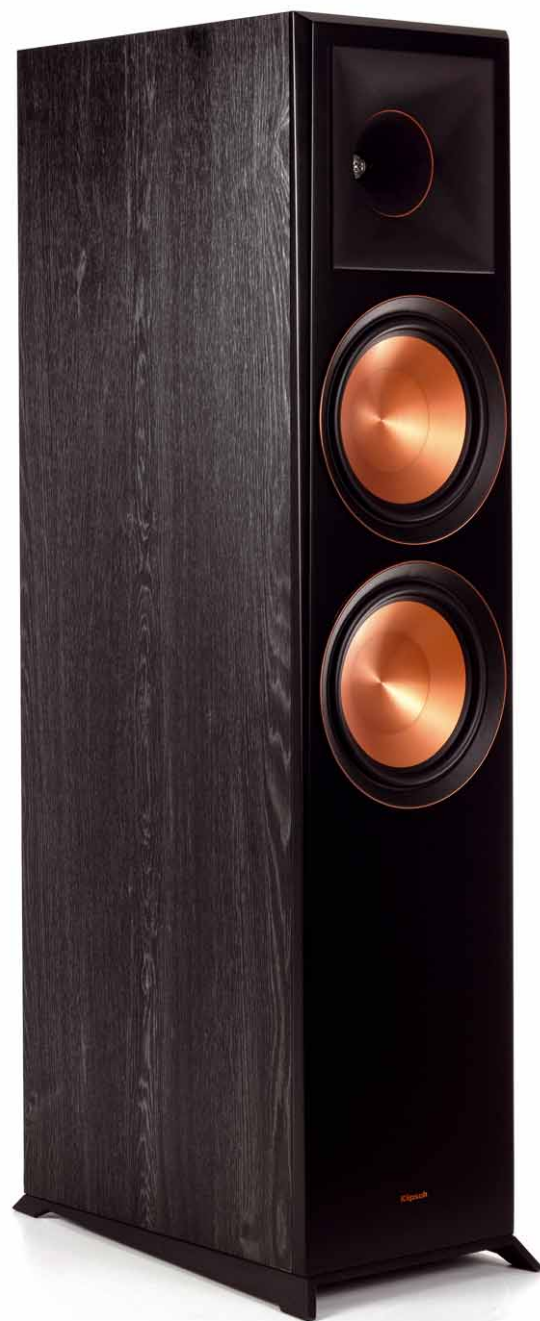
Farbe ins Spiel bringen die kupferfarbenen Membranen des Tiefmitteltöners. Das quadratische Tractrix-Horn (90° x 90°) ist an eine 25-mm-Titankalotte mit vorgelagertem Phaseplug angekoppelt
