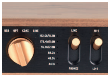
Oben: HighRes inklusive DSD. Rechts: Die Signale werden per Relais leicht zeitversetzt geschaltet.
